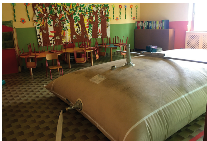
Scuola dell'Infanzia: Il serbatoio contenente 600 Kg di acqua al primo piano e i sensori con i dispositivi di misura al piano terra
