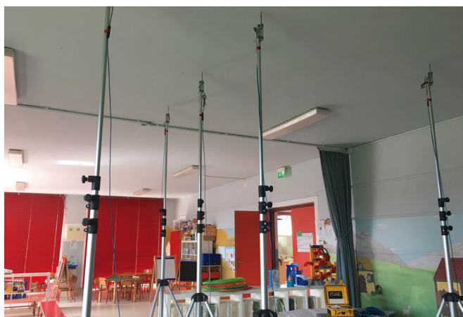
Scuola dell'Infanzia: Il serbatoio contenente 600 Kg di acqua al primo piano e i sensori con i dispositivi di misura al piano terra
